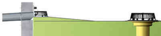
Sposób montażu odwodnienia głównego i awaryjnego
